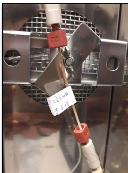
Figura 13. Columna R3 tras 7 horas de tratamiento
