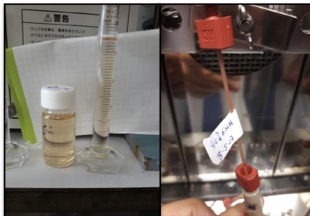
Figura 14. Izquierda: color de la disolución NPs a la entrada y a la salida de la columna. Derecha: columna R3 con las NPs unidas al polímero (12 horas de tratamiento).
