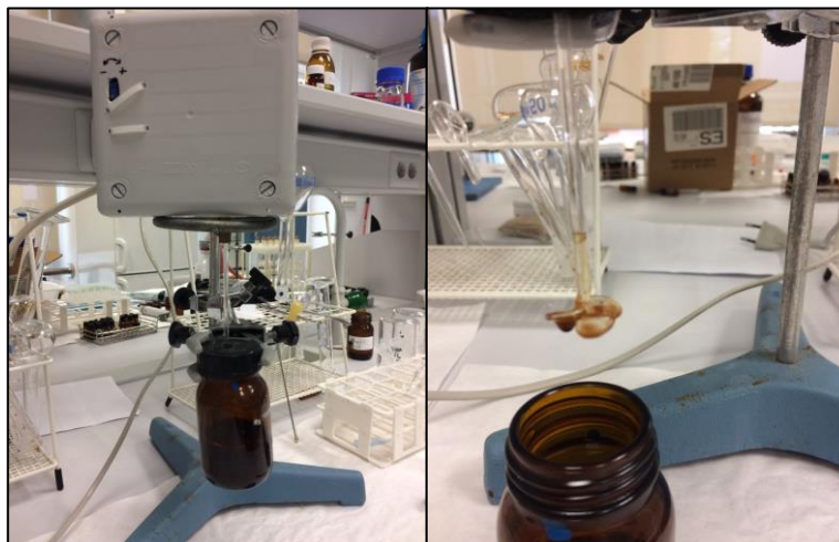
Figura 8. Montaje para la reacción de aminación de las NPs de magnetita con APTMS
