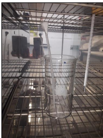
Figura 5. Columna en posición vertical en el horno para la polimerización.
