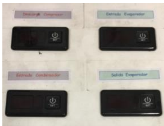
Figura 4.29. Situación de los cuatro displays modelo AKO TDP-10.
