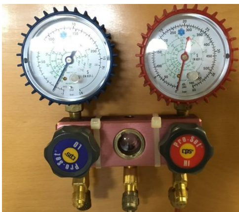
Figura 4.22. Situación de los manómetros modelo 125-P/2 en el tablero de sensores.
