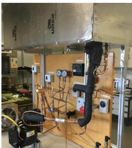
Figura 3.14. Montaje de la cámara y aislamientos.
