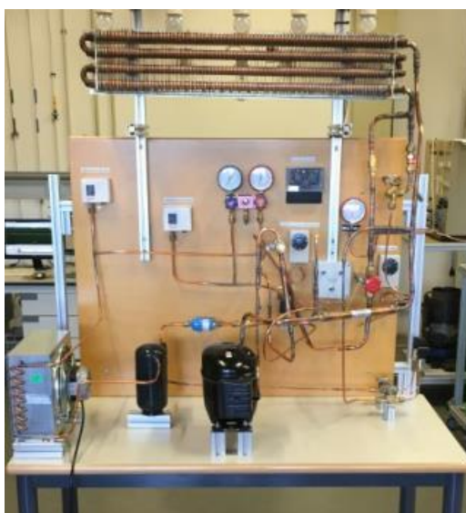
Figura 3.13. Resultado final del equipo sin la cámara frigorífica.
