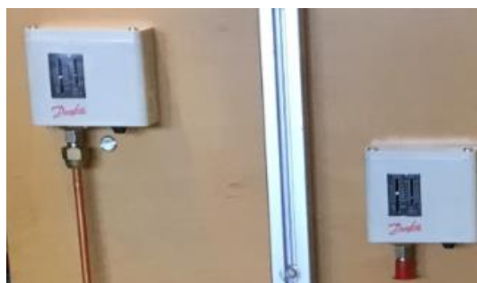
Figura 4.21. Situación de los presostatos modelo Danfoss KP1 en el tablero de sensores.
