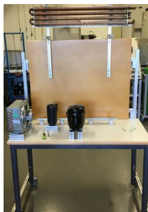
Figura 3.8. Fijación de los primeros equipos y el tablero a la bancada.
