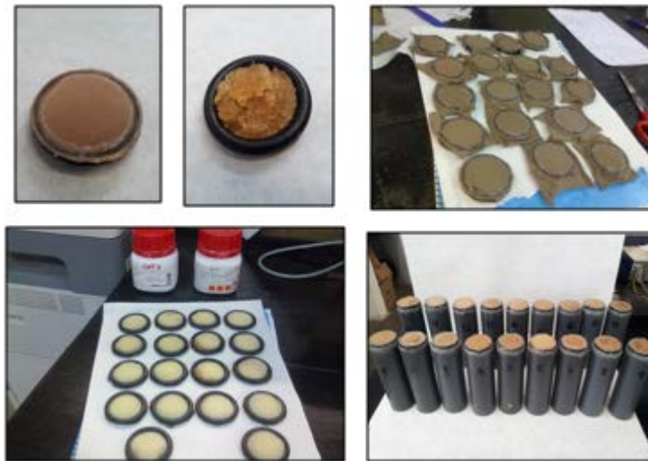
Figura 12. Proceso de elaboración de los tubos de resina
