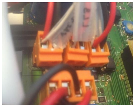
Figura 53. Fotografía del resultado final de los conectores de la placa de control con los cables procedentes de la placa de LEDs puestos (cables de color gris claro).
