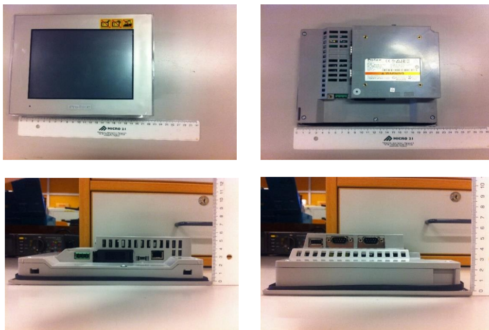
Figura 33. Imágenes de distintas perspectivas de la pantalla táctil PFXGP440ITAD del Endoworm 3.0
