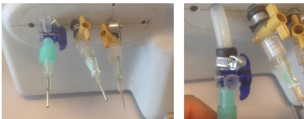
Figura 70. Fotografías del aspecto final que tienen los conectores de las cavidades del motor neumático.
