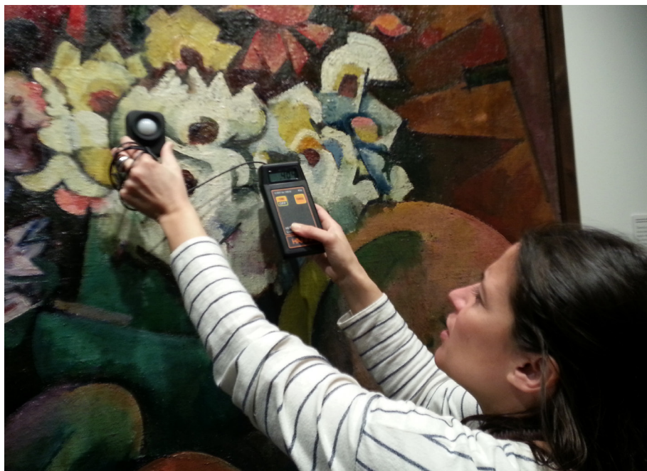
127. Cotrol mediante luxómetro Museo Arte Ruso. Málaga. 2016
