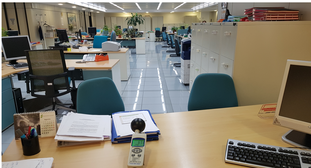
Imagen 9. Vista de la oficina, puesto de trabajo y medidor de confort térmico.
