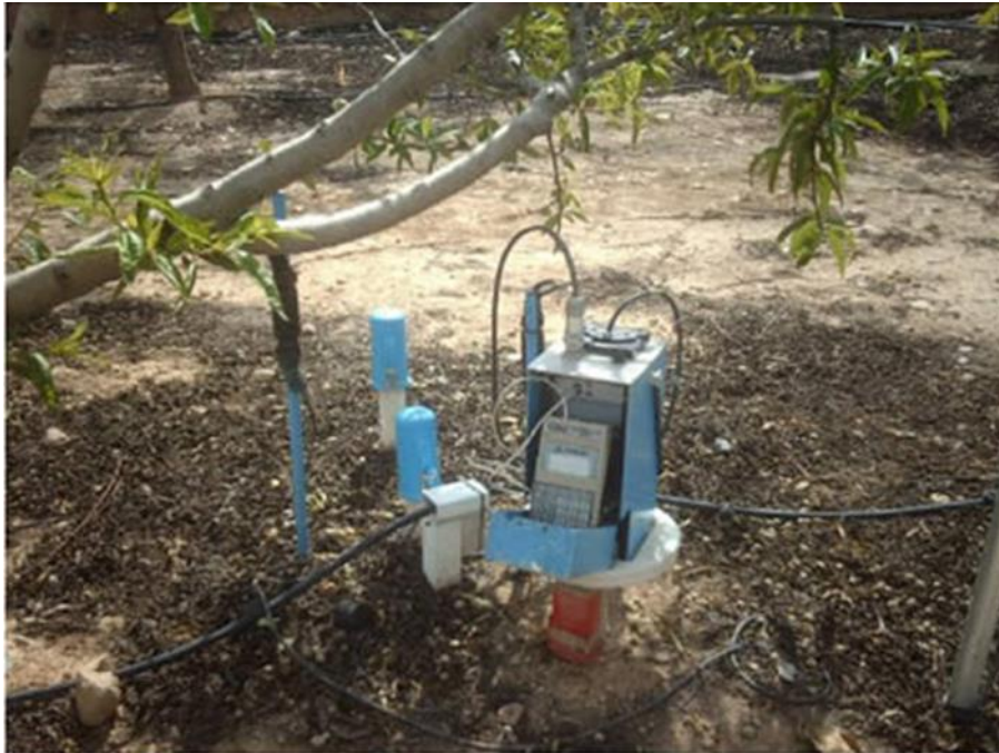
Imagen 2. Sonda de neutrones. Fuente: http://www.infoagro.com/frutas/riego_deficitario_en_melocotonero.htm
