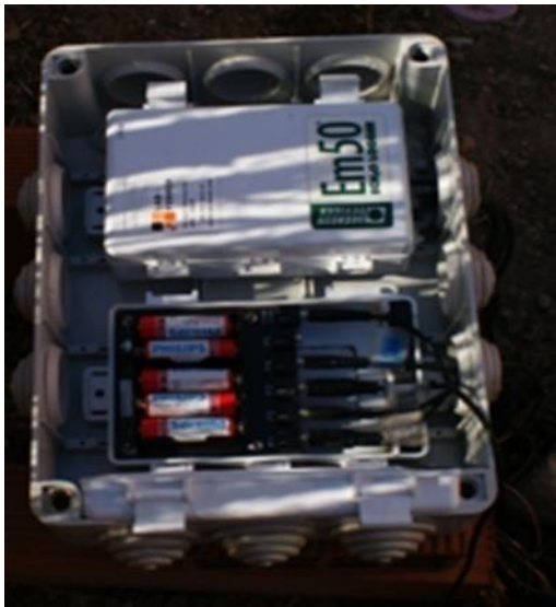
Imagen 16. Caja hermética con Dataloggers en el interior.
