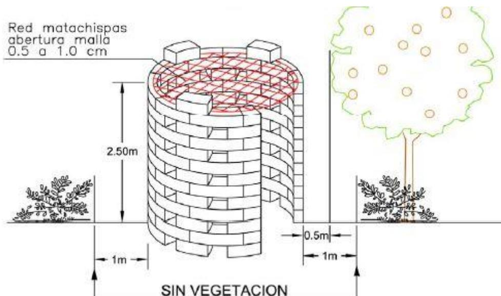
Imagen 37. Detalle del alzado de un quemador
