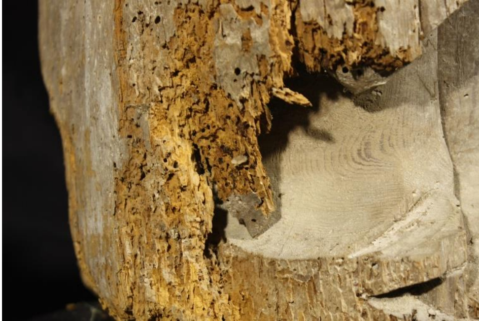
Ilustración 21. Fragmento A231: San Juan. Deterioro producido por el insecto Anobium punctatum.
