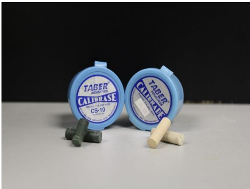
Figura 26. Puntes per a l'abrasió
