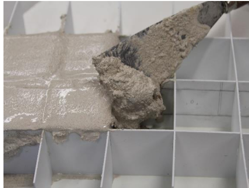
Figura 23. Abocament del morter al motlle
