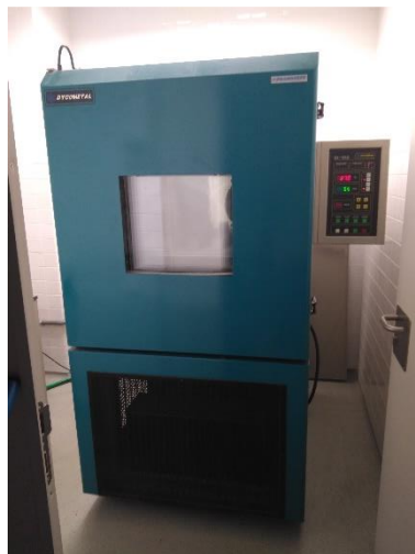
Figura 30. Càmera temperatura i humitat
