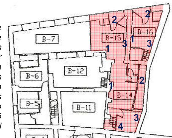
Sectorización del local de Navellos, 15, con la indicación de los números de los paramentos estudiados. Se ha de señalar que al iniciar la intervención ya habían sido demolidas ciertas estructuras que se reflejan en este plano, como son dos escaleras y ciertos muros, como los que cerraban la estancia B16 por el oeste entre B16 y B14 y el muro con paso entre B15 y B14.
