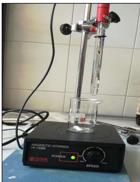
Figura 4. Montaje experimental para ajustar el pH
