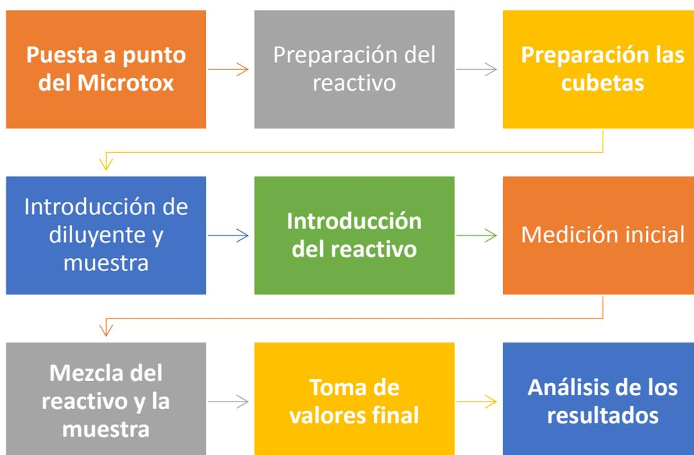
Figura 12. Esquema del ensayo con el equipo Microtox
