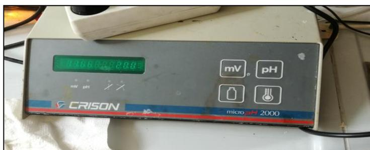
Figura 3. Medidor de pH electrónico
