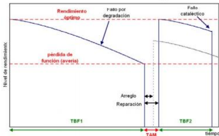
Gráfica 1. mantenimiento correctivo.
