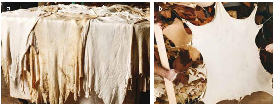
Figura 2 (a-b). Elaboración de un pergamino. a) Diferentes pieles, cordero y ternera, previo al tratamiento. b) Proceso de secado, realizado por tensando de la piel una a una sobre un bastidor de madera, consiguiendo aumentar su tamaño, controlar su espesor y asegurar la uniformidad del pergamino.
