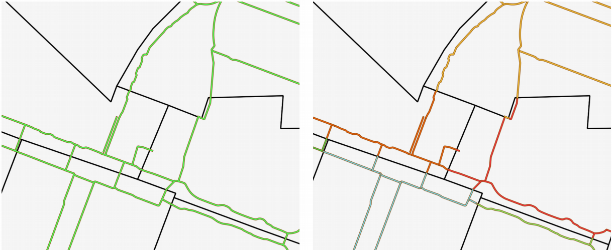
Figura 30: Aplicación de la función ST_Intersection a la capa de carril bici con barrios. A la izquierda se aprecia como las líneas son continuas sin separación entre barrios, a la derecha se puede ver según el color el carril bici en función del barrio en el que se ubica. Elaboración propia.
