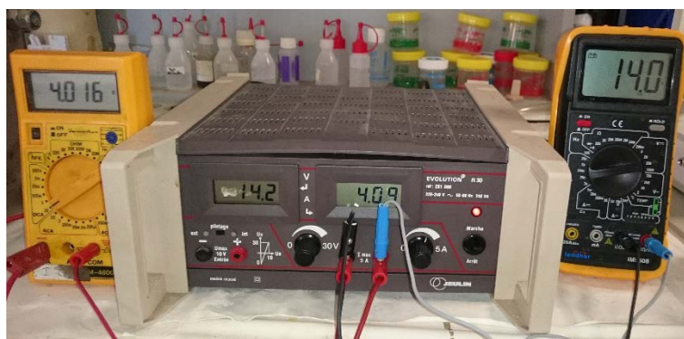
Figura 6. Fuente de alimentación de corriente continua JEULIN EVOLUTION R30, 220-240V y dos multímetros
