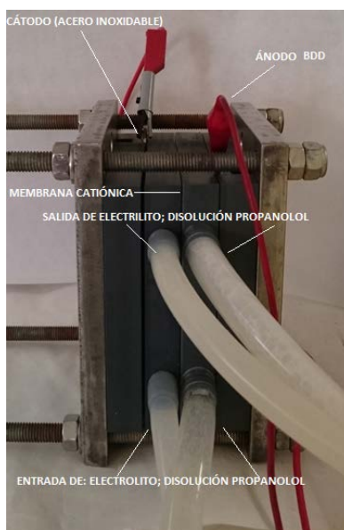
Figura 7. Reactor de electrodos planos paralelos
