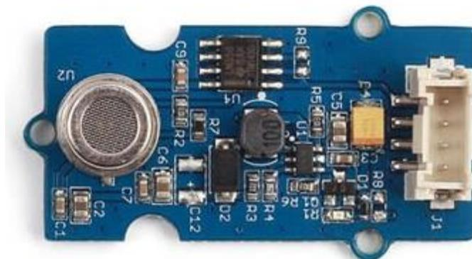
Figura 12 Sensor calidad del aire. Air Quality Sensor v1.3
