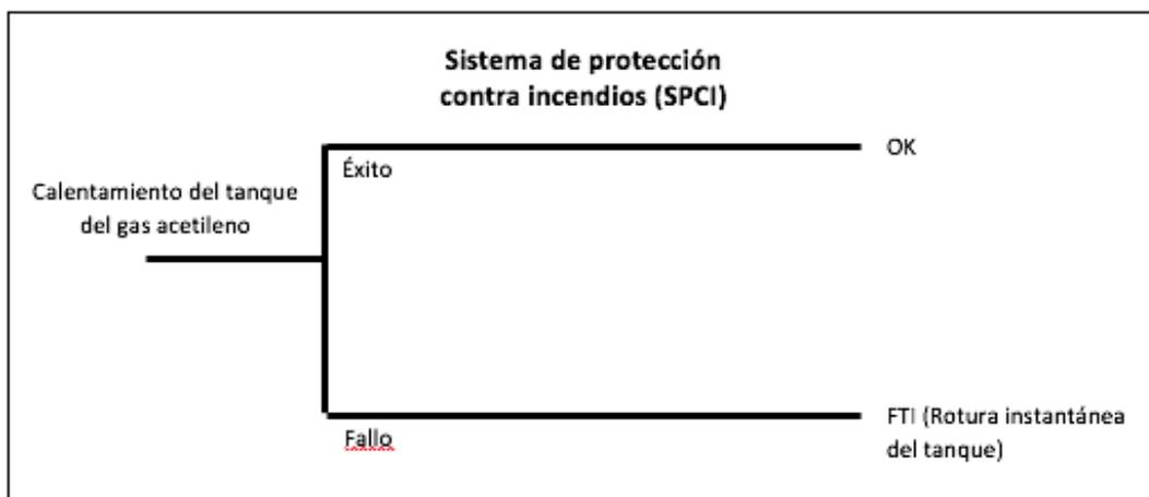
Figure 22. Árbol de eventos para el pre-accidente "Calentamiento del tanque del gas de acetileno"
