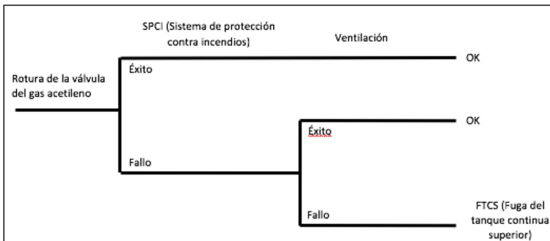
Figure 18. Árbol de eventos para el pre-accidente "Rotura de la válvula del gas de acetileno"
