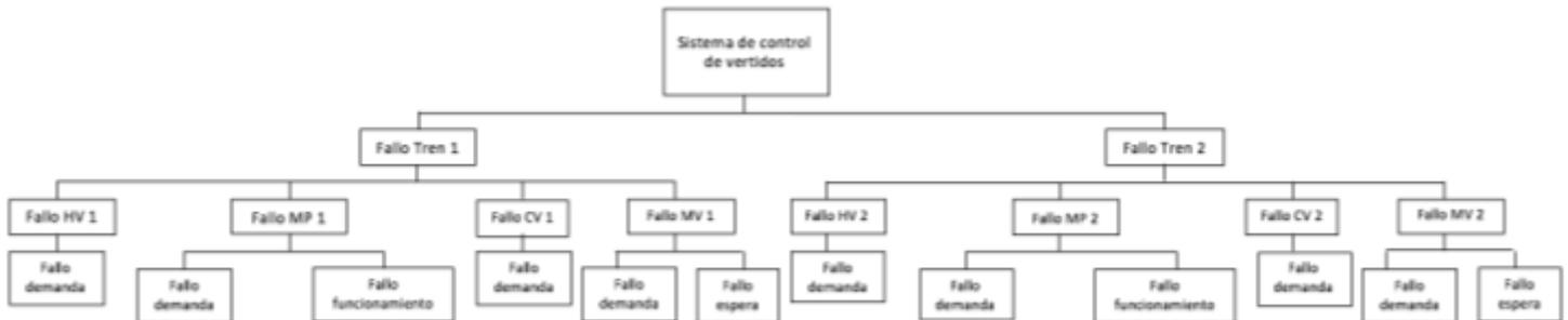
Figure 26. Árbol Esquema de equipos Sistema de Vertidos "Rotura total del envase de etileno"
