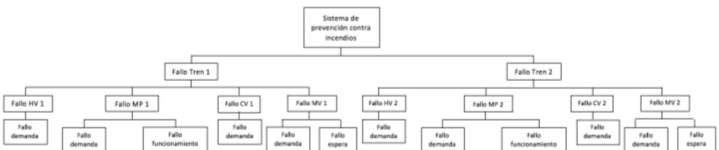
**Figure 30.** Árbol Esquema de equipos SPCI "Rotura de la válvula de gas de hidrógeno"
