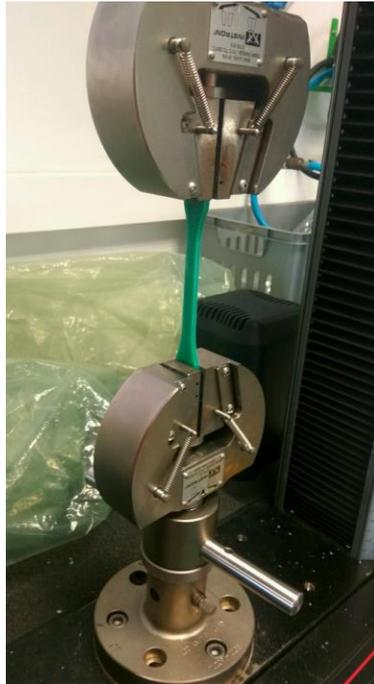
**Figura 7.** Probeta sometida a tracción.
