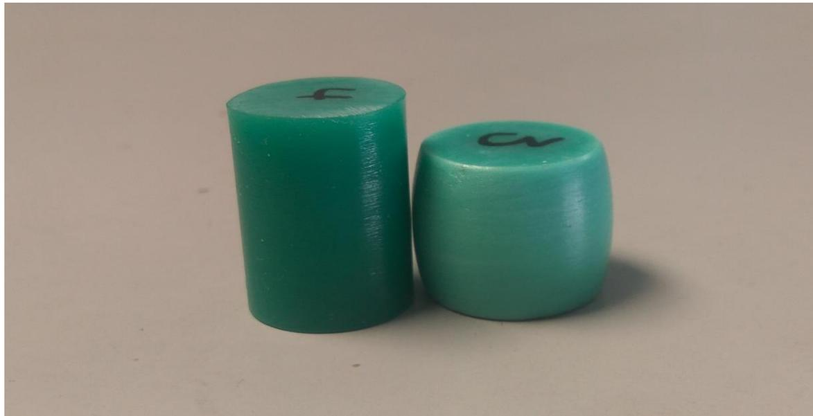
**Figura 11.** Probetas del producto N°1, antes y después del ensayo de compresión.
