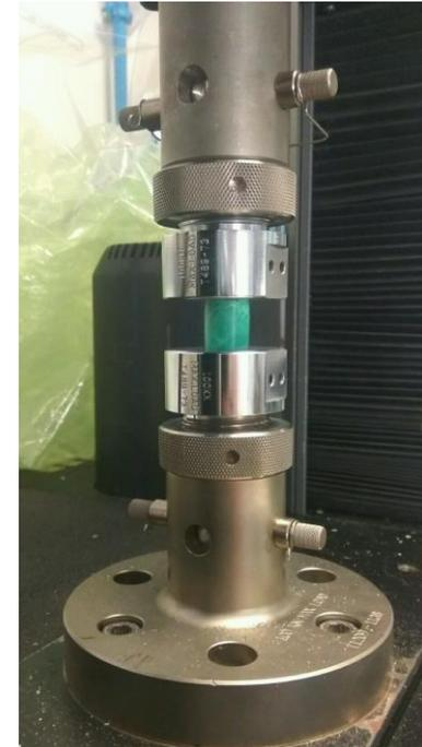
**Figura 8.** Probeta sometida a compresión.
