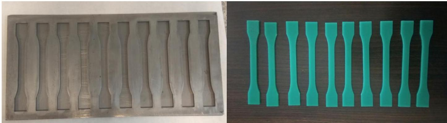
**Figura 4.** Moldes para probetas de tracción y probetas de tracción 1B.
