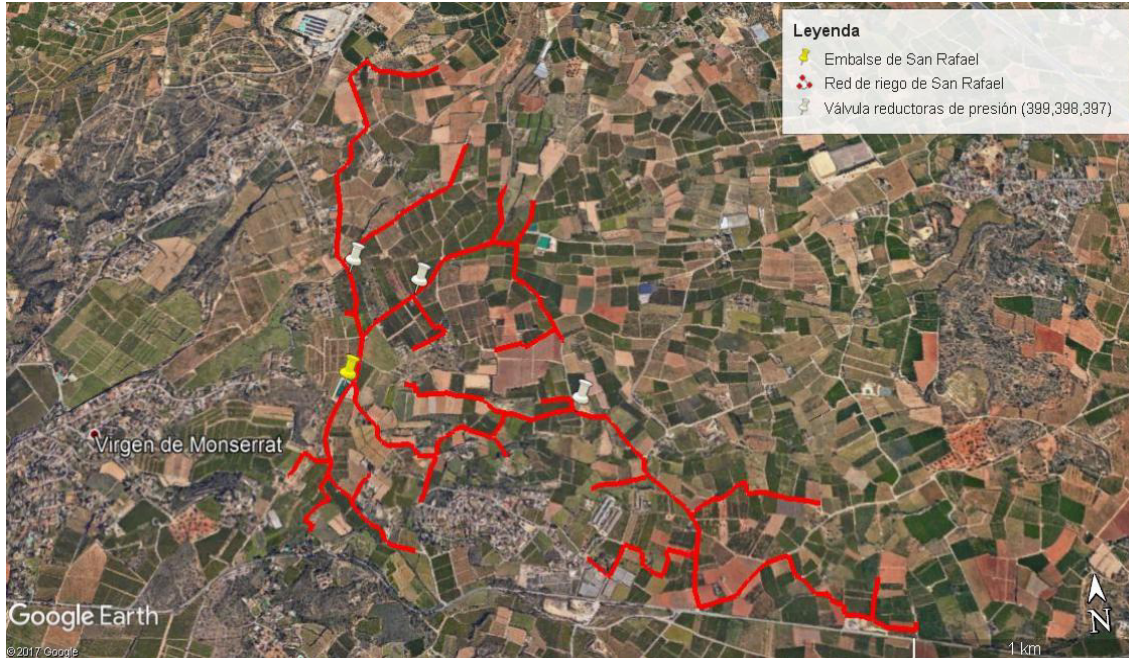
Figura 17. Imagen vía satélite de la red de San Rafael con la marcación geográfica en la que se deber colocar las válvulas reductoras de presión para llevar a cabo la mejora de la red de riego. Fuente: Propia
