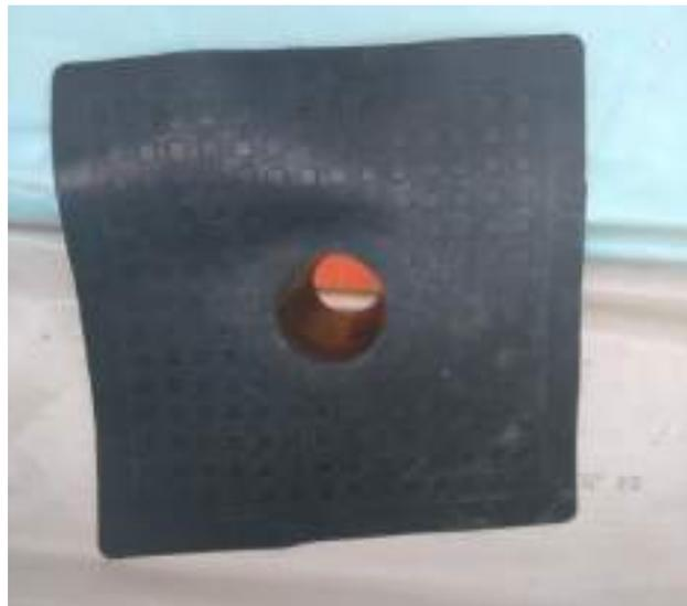
Fotografía 7 - Aliviadero con embocadura de diámetro de 19mm
