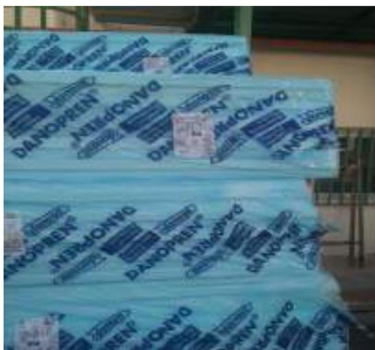
Fotografía 3- Panel extruido de 80mm
