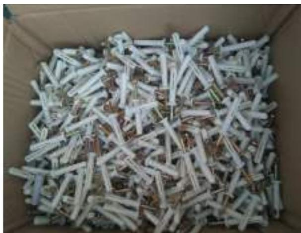
Fotografía 11- Tornillería para sostener la lámina EPDM en la viga
