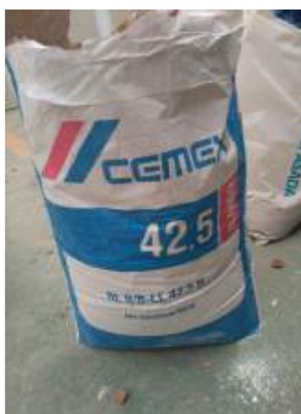
Fotografía 19 - Cemento CEMII/BLL/42,5R para la reparación del alero C34
