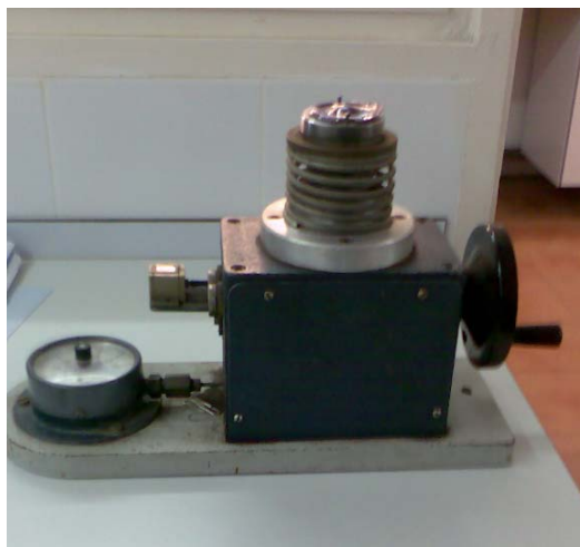
Figura 3.11. Aparato para medir la elasticidad de la flor
