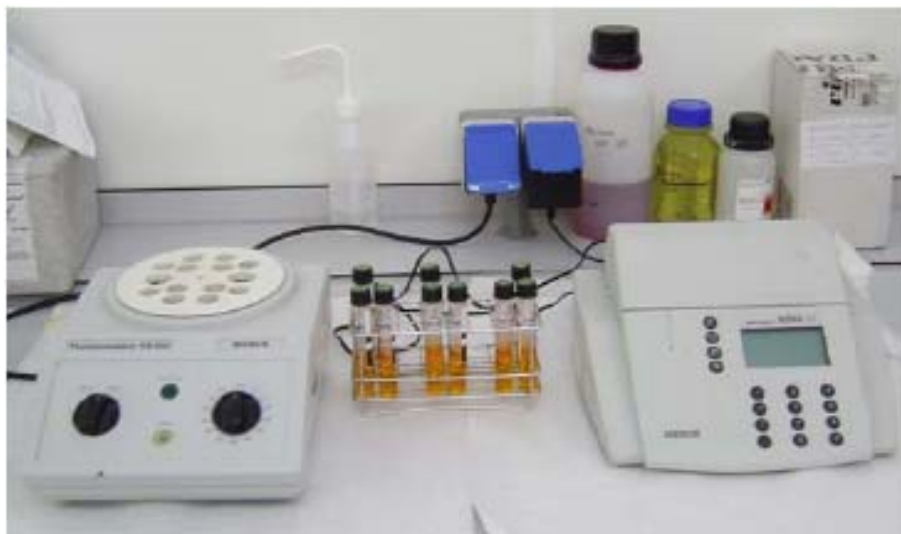
Figura 3.7. Espectrofotómetro y termoreactor de la DQO
