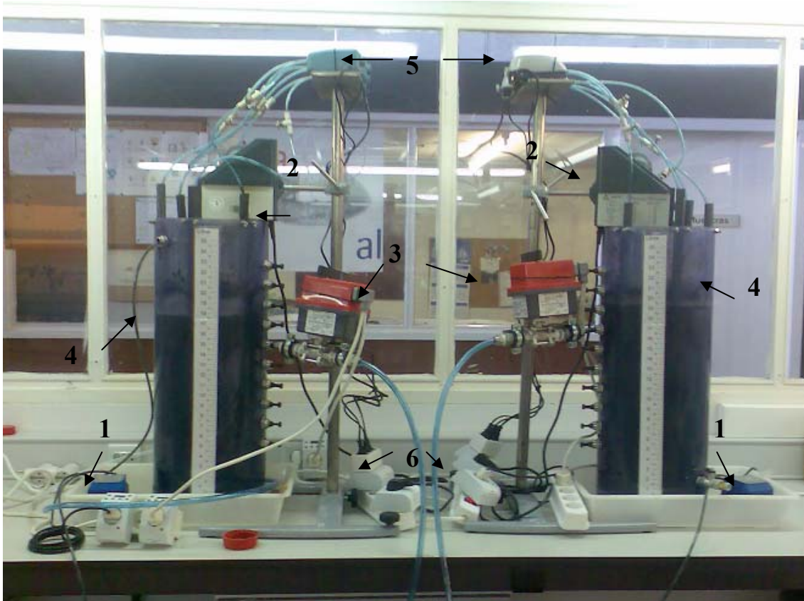
Figura 3.21. Planta piloto de SBR con dos reactores en paralelo
