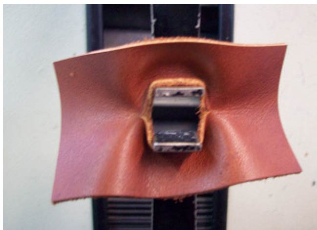
Figura 4.25. Probeta durante el ensayo de desgarro en la reutilización del baño de pelambre en el remojo
