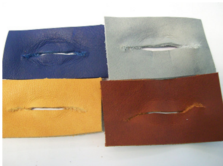
Figura 4.38. Probetas tras el ensayo de desgarro en la reutilización del baño de píquel
