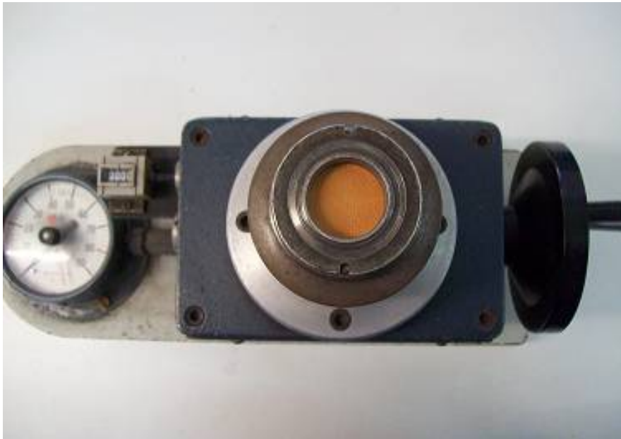
Figura 3.12. Fijación de la probeta de elasticidad al aparato de tracción
