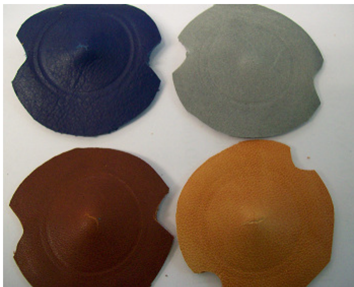
Figura 4.50. Probetas tras el ensayo de elasticidad en la reutilización del baño de curtición
