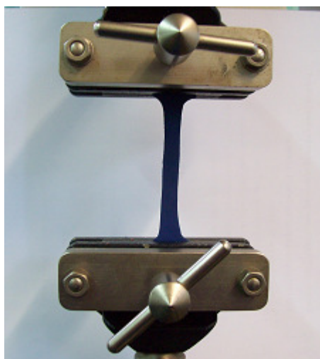
Figura 4.22. Probeta durante el ensayo de tracción en la reutilización del baño de pelambre en el remojo
