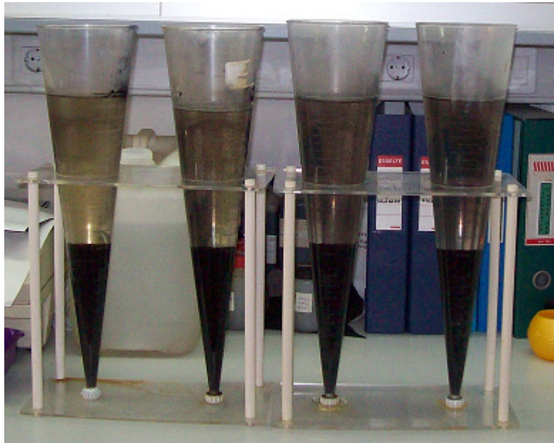
Figura 4.77. Apariencia del sobrenadante para el ensayo: 100 mg/l CF, pH 9 y concentración de floculante variable
