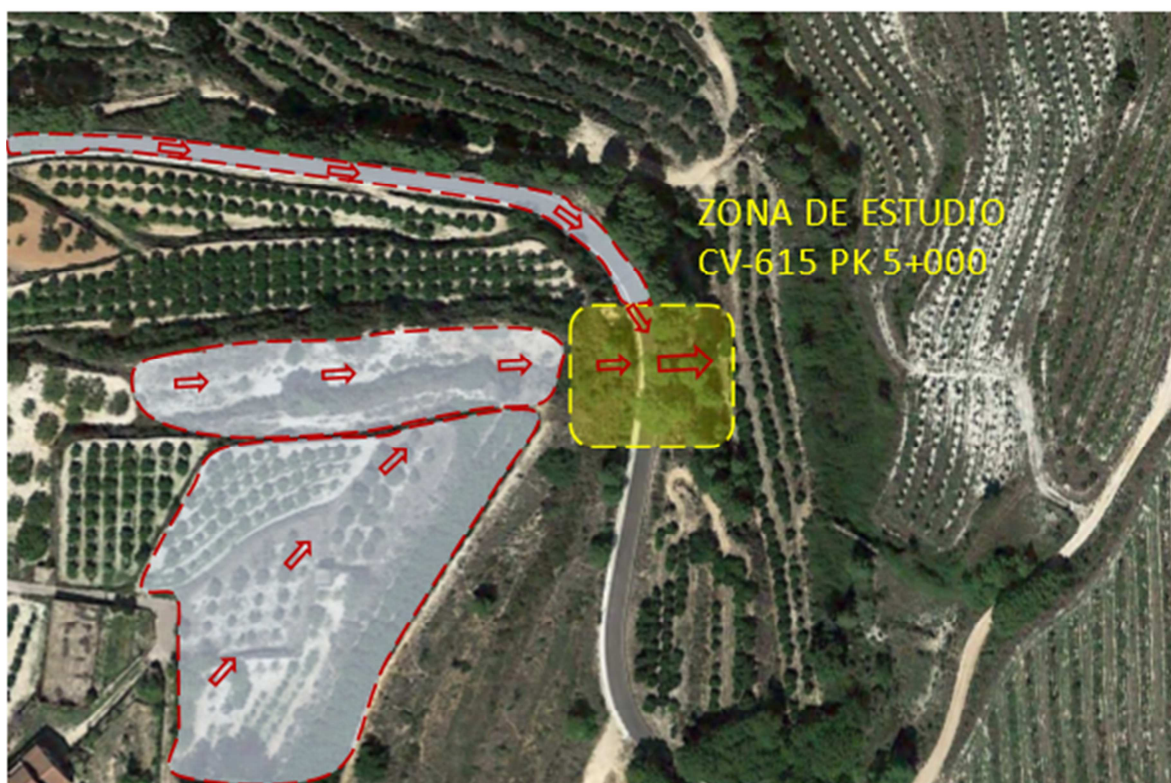
Figura 14. Punto de captación de aguas de la CV-615 y campos arriba del talud superior.
