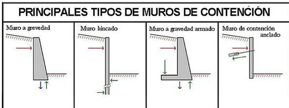
Figura 27. Tipología de muros más empleados.
