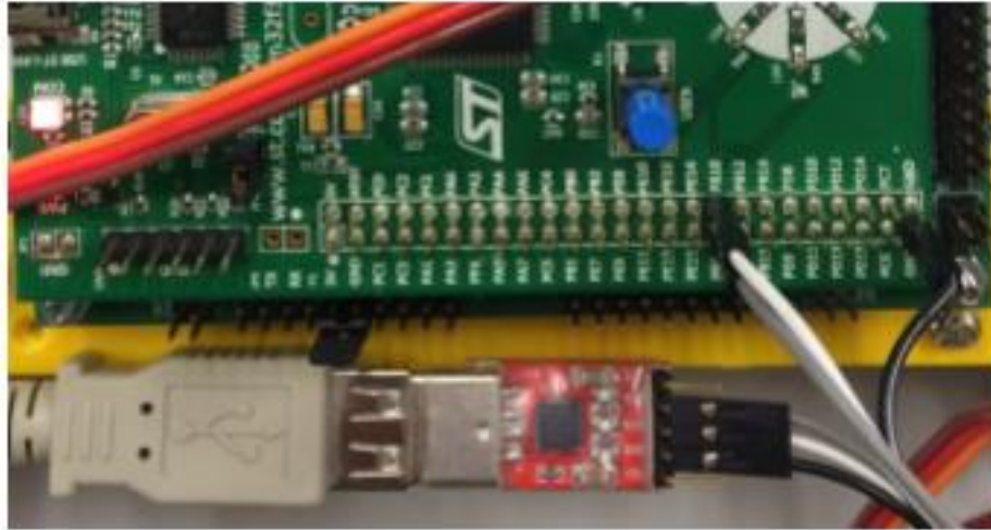
Figura 73: Conexión de la serie a USB
