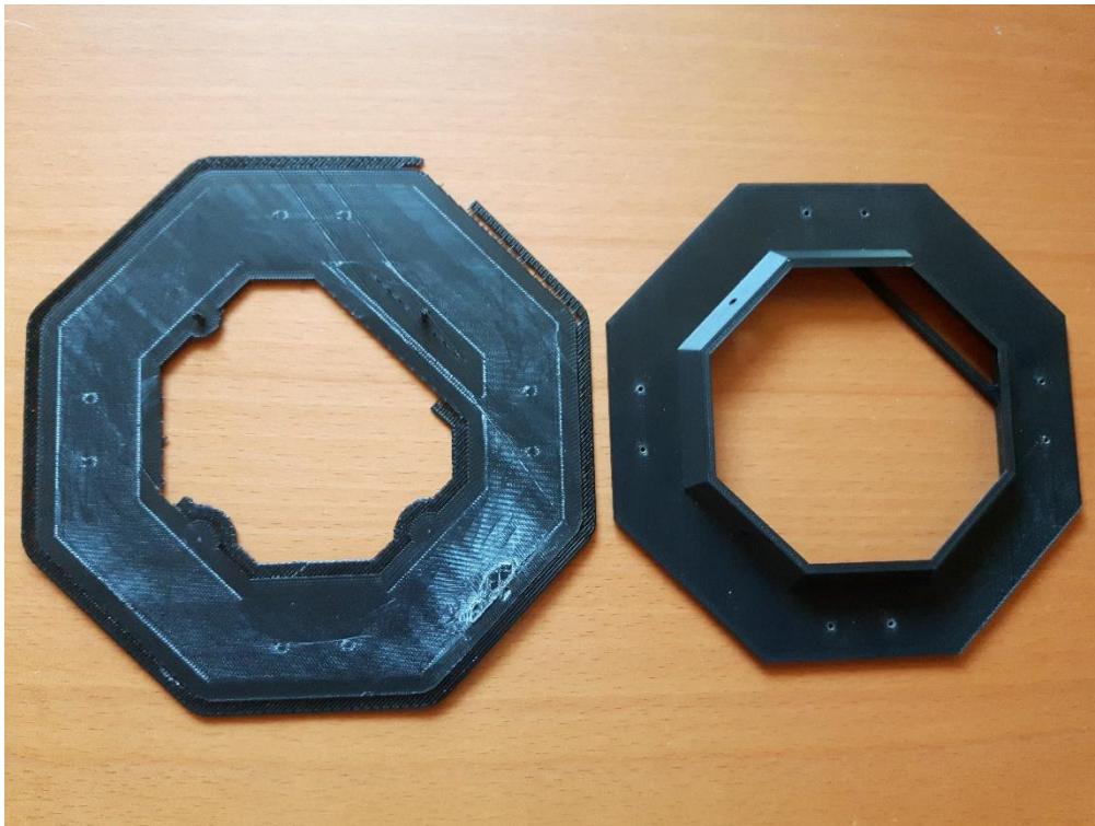
Figura 35 y 36 : piezas imprimidas con y sin soporte
