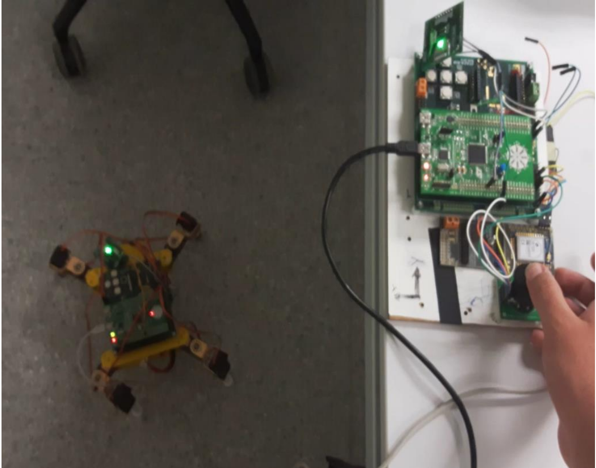
Figura 82: Montaje del robot cuadrúpedo 2DOF y su controlador
