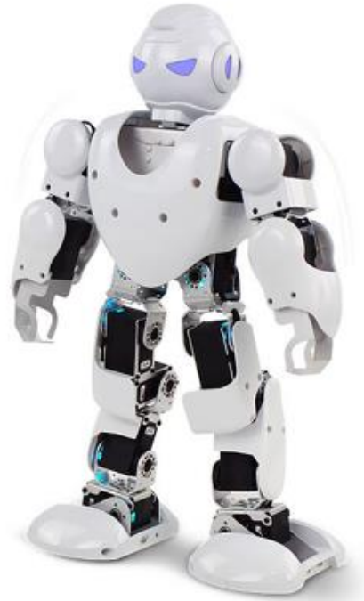
Figura 15: Robot humanoide de 17GDL construido con servomotores DOMAN 1513MD
