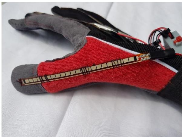
ILUSTRACIÓN 31: 'MONTAJE SENSOR DE FLEXIÓN'
