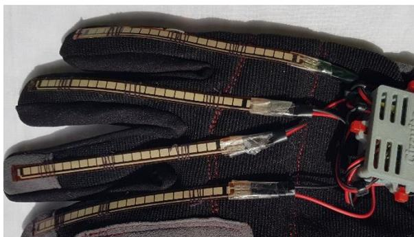
ILUSTRACIÓN 15: 'DISPOSICIÓN DE SENSORES DE FLEXIÓN'
