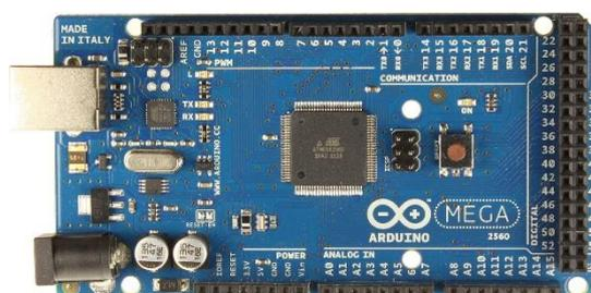
ILUSTRACIÓN 22: 'ARDUINO MEGA'
