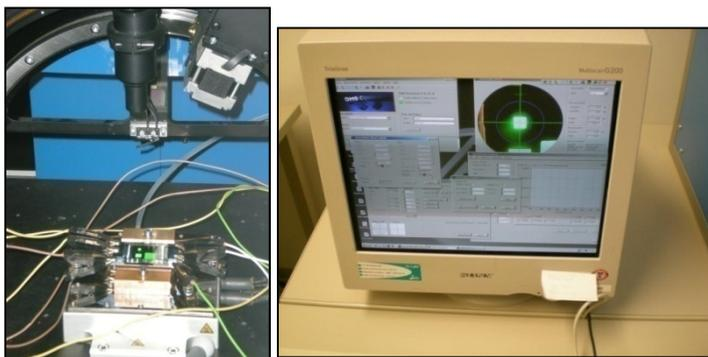
**Figura 80.** A) Componente automatizado del microscopio-radiómetro enfocado sobre un OLED referencia anclado a la placa calefactora. B) Pantalla del software de control mediante PC.
