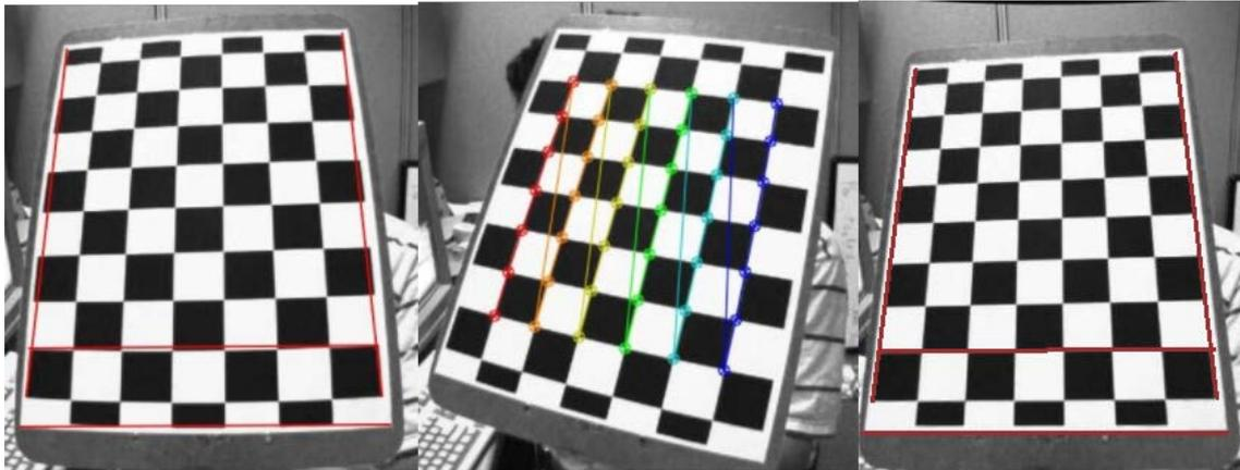
**Figura 2.14:** Proceso de calibración y rectificación de las cámaras con OpenCV. Inicialmente, la imagen posee una distorsión radial de tipo barril (izquierda). Tras el proceso de calibración (centro), se aplica la rectificación calculada corrigiendo la distorsión (derecha). (Imágenes extraídas de [82]).
