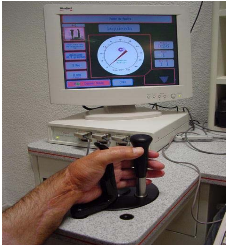
Figura 24. Montaje para presión isocinética.
