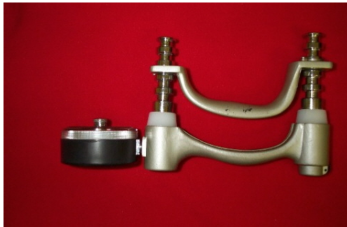
Figura 12. Detalle de las distintas posiciones del dinamómetro. Situado en Posición III
