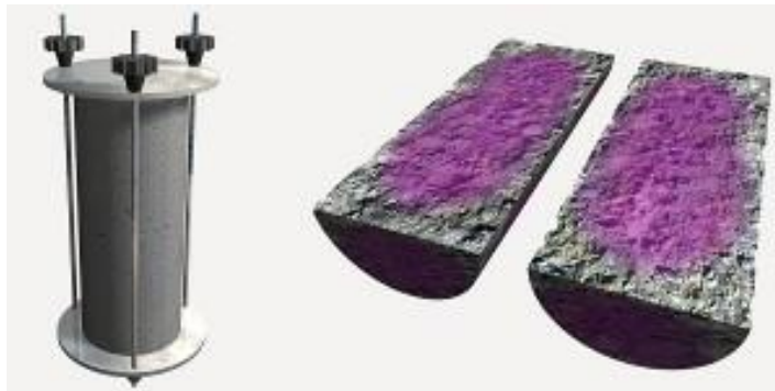
Ilustración 42. Prueba de la fenolftaleína. www.teoriadeconstruccion.net . Agosto 2017
