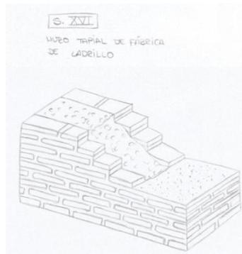
Ilustración 11: Muro tapial de fábrica de ladrillo. Elaboración propia.
