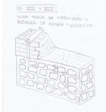
Ilustración 12: Muro tapial de hormigón con bloques de piedra y guijarros. Elaboración propia.
