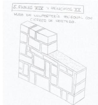
Ilustración 14: Muro de mampostería poligonal con cierres de mortero. Elaboración propia.
