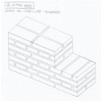
Ilustración 13: Muro de ladrillos trabados. Elaboración propia.
