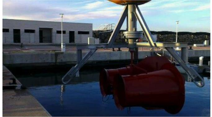
Fig. 14. Implementación de los canales de aumento en el prototipo.
