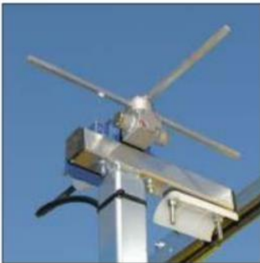
Final de carrera para traslación de puente.
