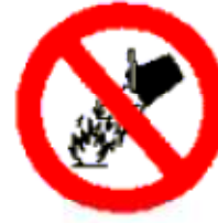
Prohibido apagar con agua
