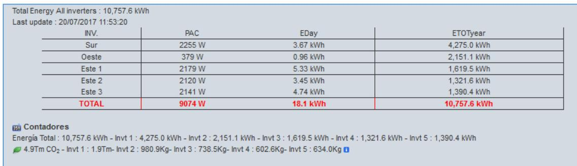
Figura 42. Energía en Kwh producidos en los distintos inversores. Fuente CIEMAT
