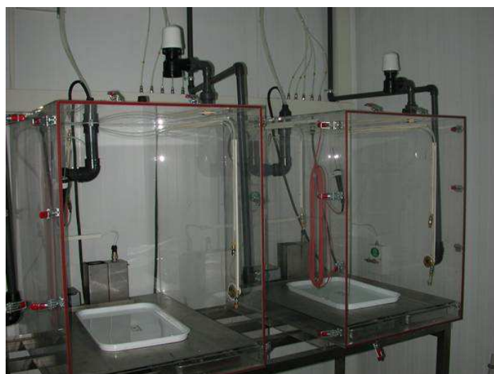
Foto 2. Cabinas utilizadas para la aplicación de atmósferas insecticidas (Centro de Tecnología Poscosecha, IVIA, Valencia, España).
