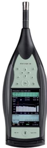
**Figura 12.** Sonómetro utilizado en las mediciones 2250 Bruel Kjaer
