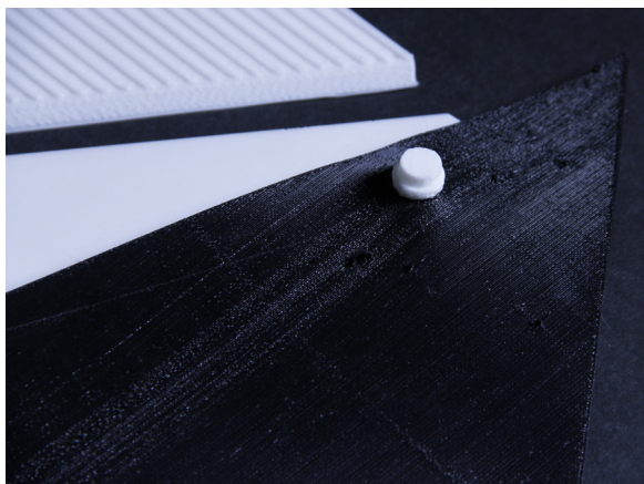
Fig. 97: Detalle de pletina entre PLA y Filaflex negro.
