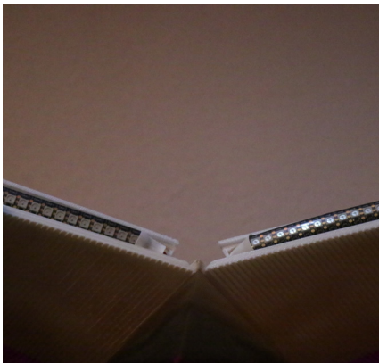
Fig. 119: Detalle del ángulo del cuello con la electrónica ensamblada a las piezas finales.
