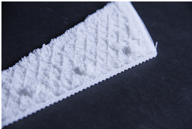
Fig. 92, 93, 94: Detalles de la baja calidad de resolución en la base de las piezas.
