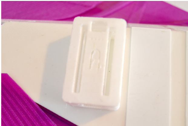
Fig. 105: Cajas de protección para las placas computadoras.
