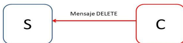
Imagen 18. Envío mensaje DELETE desde el cliente (C) y el servidor (S). El servidor no responde a este tipo de mensajes. Si recibe un mensaje de este tipo, restará en una unidad el nº de usuarios
