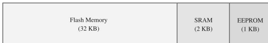
Figura 12: Esquema de la memoria placa Arduino UNO
