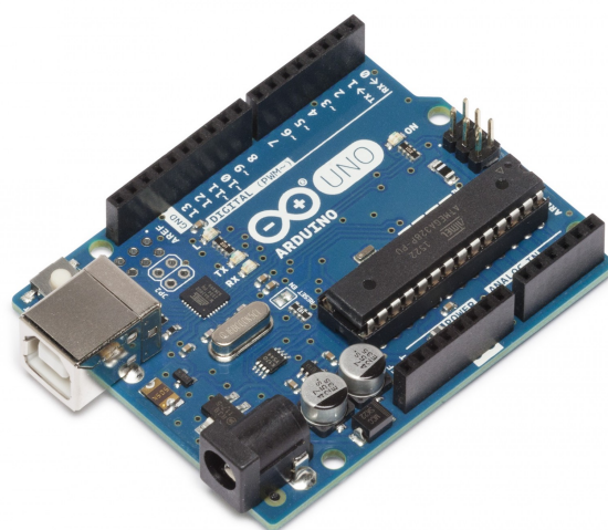
Figura 8: Placa Arduino UNO Rev3
