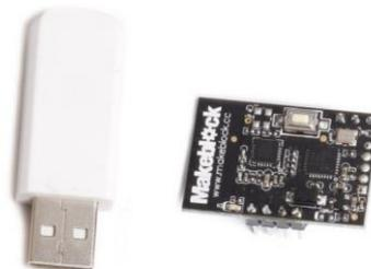
ILUSTRACIÓN 16 MÓDULO WIRELESS PARA ROBOT
