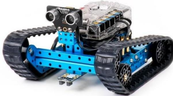
ILUSTRACIÓN 13 ROBOT TIPO ORUGA DE MAKEBLOCK
