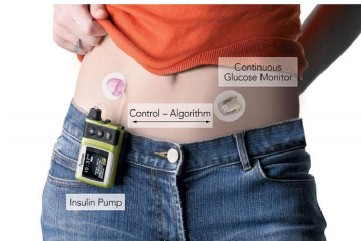
**ILUSTRACIÓN 12 EJEMPLO DE SISTEMA DE PÁNCREAS ARTIFICIAL**
