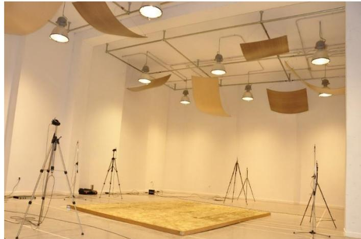
Ilustración 3.2: Difusores de 3 m<sup>2</sup> y 2 m<sup>2</sup> instalados.
