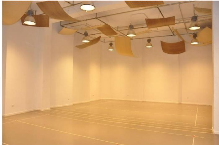
Ilustración 3.3: Difusores de la cámara reverberante del IIE.
