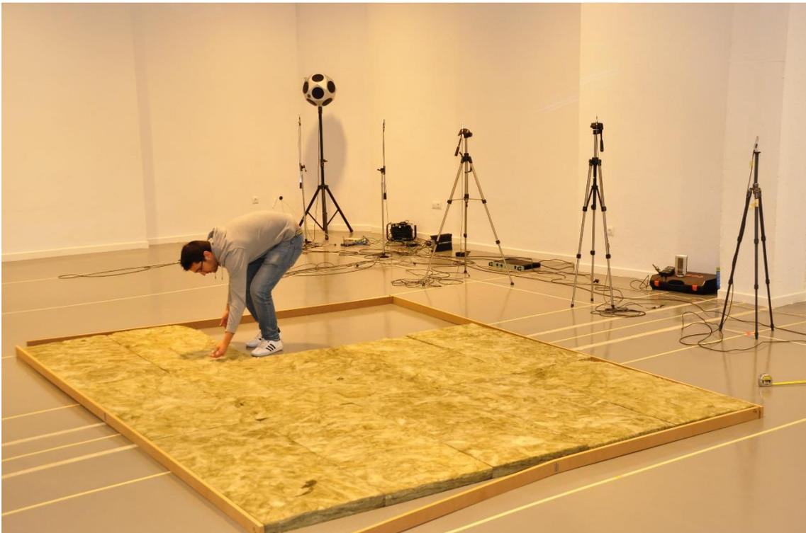
Ilustración 2.11: Colocación de la muestra absorbente y marco perimetral.
