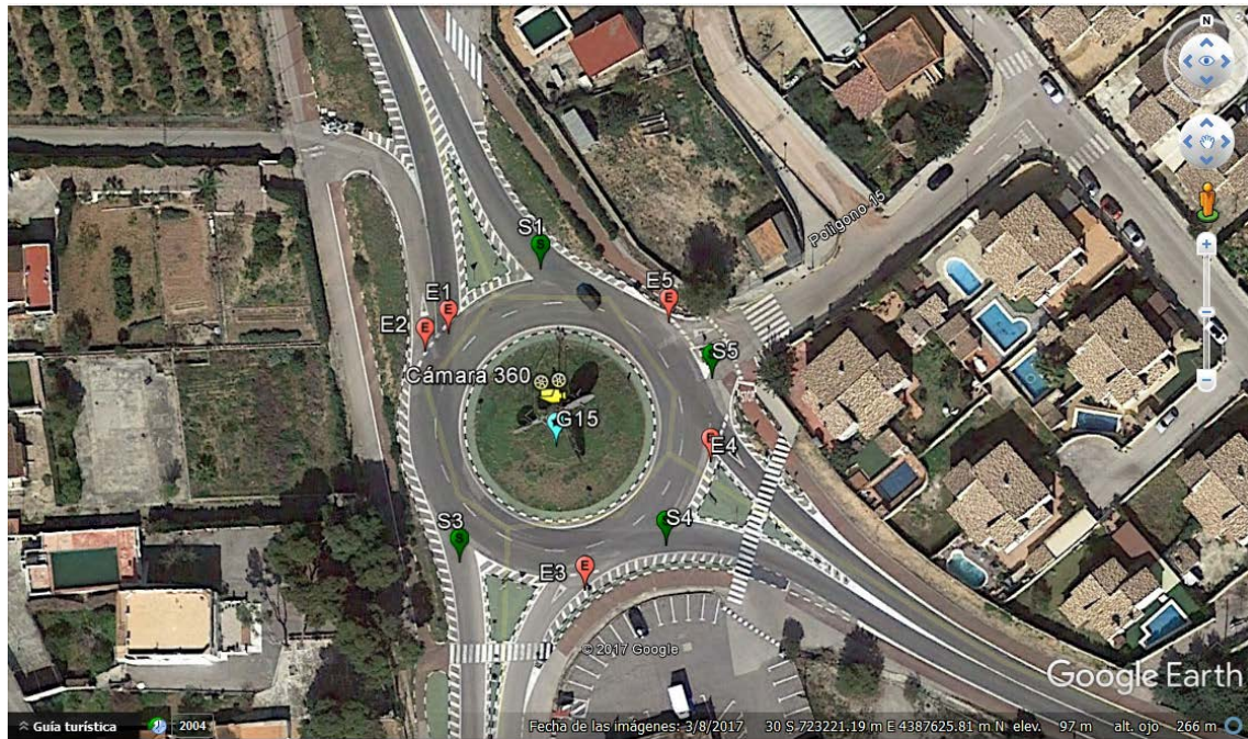
Fig. 159 Glorieta G15 grabada y con posible ubicación de cámara 360.
