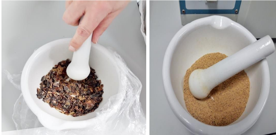
Figura 3.5.8 Pulverizado de las muestras secas en mortero.
