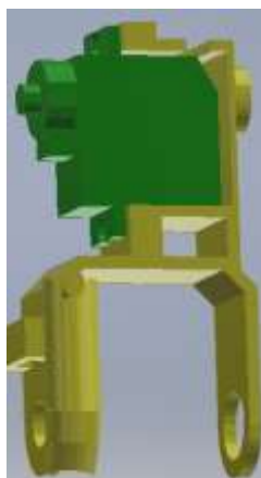
Imagen 48. Módulo brazo con servo atornillado.
