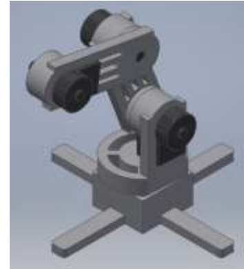
Imagen 62. Conjunto de las partes Base, Base giratoria, Brazo y Antebrazo.
