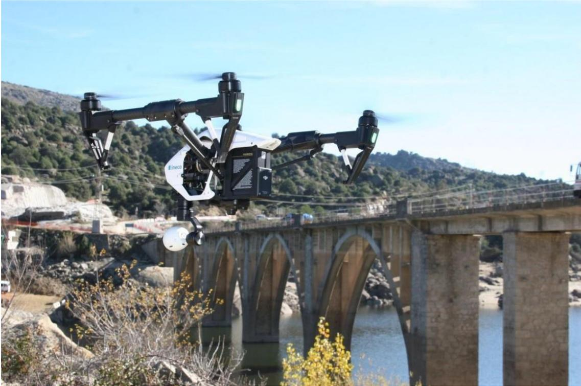
**Figura 3 – Dron capaz de realizar fotografía, filmaciones y levantamientos aéreos (levantamientos topográficos, fotogrametría).**
