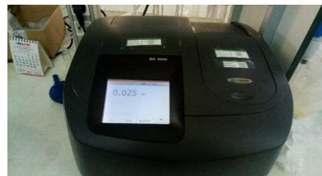
**Figura 2.6.3.** Espectrómetro de luz visible
