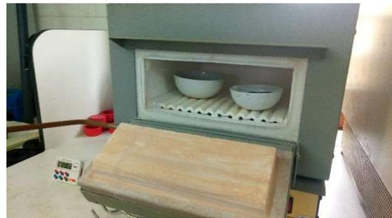
Figura 2.7.2. Mufla regulable con recirculación de aire
