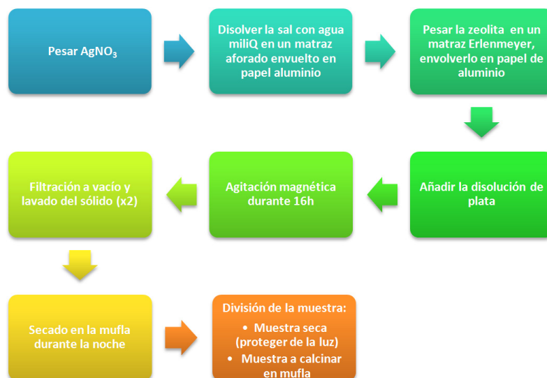
Figura 7.2. Esquema de las etapas de la síntesis de las zeolitas Ag-LTA.
