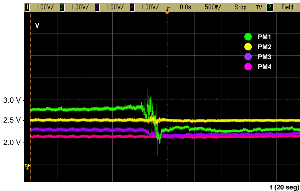
Figura IV94. Resultados de la tensión eléctrica con respecto al tiempo en el momento de la recuperación al eliminar la deformación por presión en la banda conductora 1.
