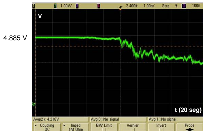
Figura IV41 Conductividad eléctrica en el tiempo obtenido en el punto de medida después de mantener un estiramiento hacia la derecha y volver a la posición inicial.
