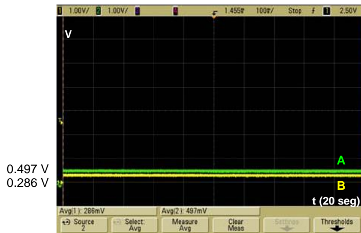
Figura IV27. Conductividad eléctrica en el tiempo para el punto de medida A y B, y después de cortocircuitar la banda conductora 1 con tres piezas de cobre en sentido horizontal entre la toma de tierra y el punto de medida.
