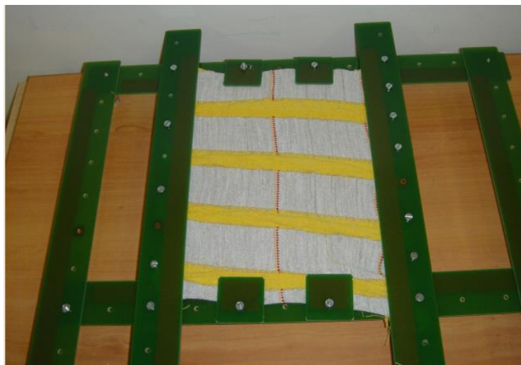
Figura III28. Fotografía del banco de ensayos para el estudio de la sensibilidad a la presión de tejidos de punto.
