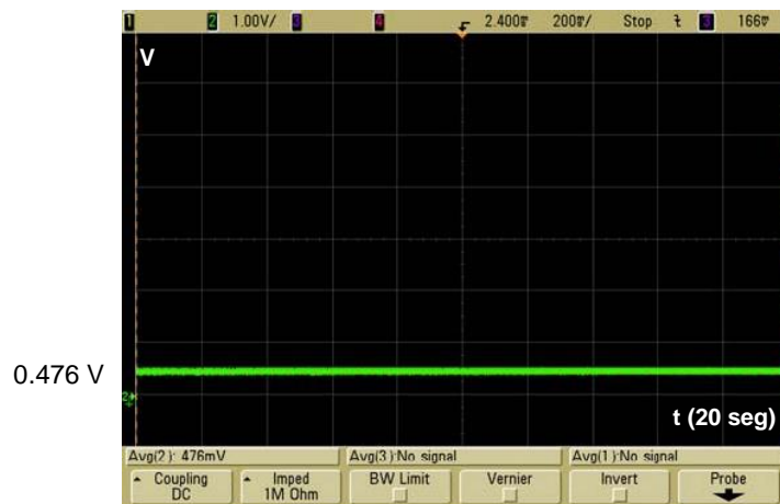
Figura IV35. Conductividad eléctrica en el tiempo obtenido en el punto de medida después de realizar un estiramiento hacia la izquierda y mantenerlo estirado.
