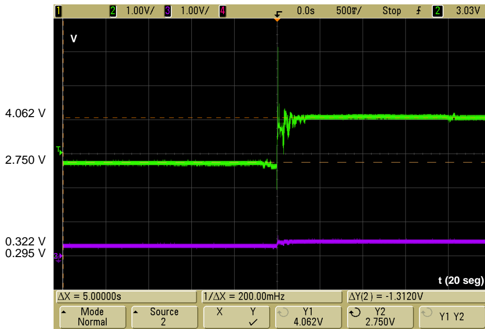
Figura IV84. Resultados de la tensión eléctrica con respecto al tiempo en los dos puntos del sistema al colocar una pesa de 50 g en un lado de la primera banda conductora.
