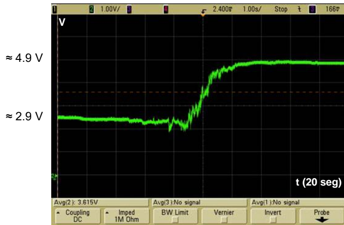
Figura IV39. Conductividad eléctrica en el tiempo obtenido en el punto de medida después de realizar un estiramiento hacia la derecha de 3 cm.
