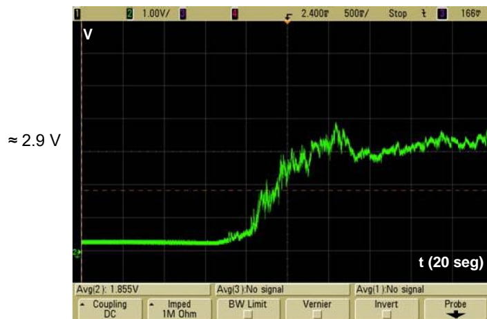
Figura IV36. Conductividad eléctrica en el tiempo obtenido en el punto de medida después de mantener un estiramiento hacia la izquierda y volver a la posición inicial.
