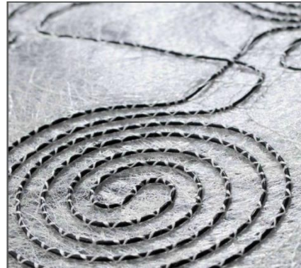
Figura 137. Bordado de textiles conductores (e-broidery)
