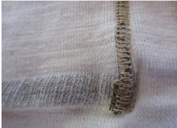
Figura IV51. Fotografías de la conexión del hilo conductor bordado con uno de los extremos del sensor textil
