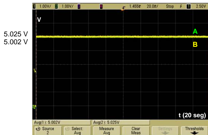
Figura IV22. Conductividad eléctrica en el tiempo para el punto de medida A y B, y después de cortocircuitar la banda conductora 1 con una pieza de cobre.
