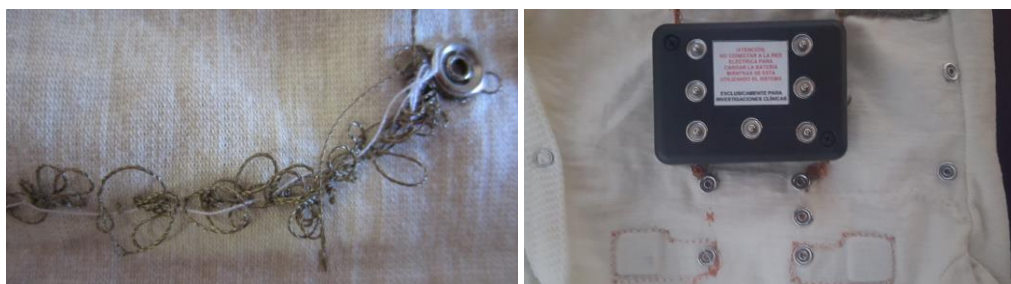
Figura IV52. Fotografías de las conexiones de los elementos electrónicos y fuente de alimentación
