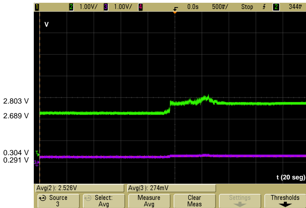
Figura IV82. Resultados de la tensión eléctrica con respecto al tiempo en los dos puntos del sistema al colocar una pesa de 10 g en un lado de la primera banda conductora.
