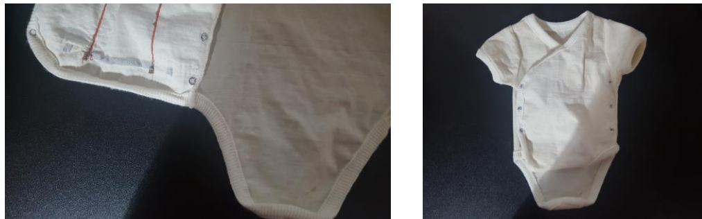
Figura IV53. Fotografías de la solapa (izquierda) y del prototipo final de body inteligente para la medida de la respiración del bebé.
