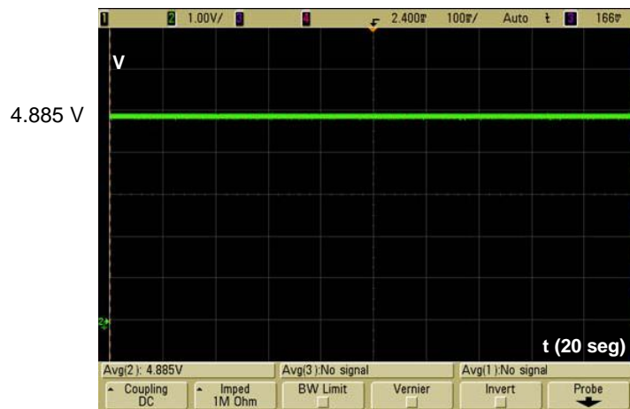
Figura IV40. Conductividad eléctrica en el tiempo obtenido en el punto de medida después de realizar un estiramiento hacia la derecha y mantenerlo estirado.
