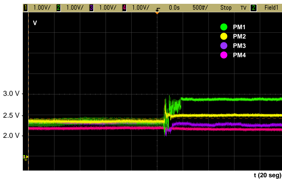
Figura IV93. Resultados de la tensión eléctrica con respecto al tiempo una producida la deformación por presión en la banda conductora 1.
