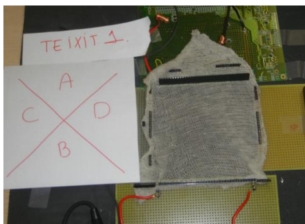
Figura III30. Fotografía del banco de ensayos de diagonales cruzadas para el estudio de la sensibilidad a la presión de tejidos de punto.
