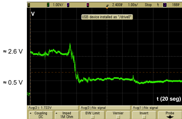
Figura IV34. Conductividad eléctrica en el tiempo obtenido en el punto de medida después de realizar un estiramiento hacia la izquierda de 3 cm.
