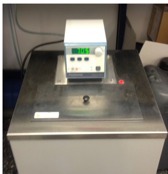
Figura 3.6: Fotografía del sistema de refrigeración
