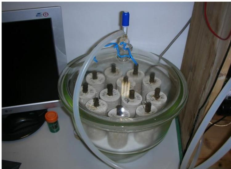
Fig. 8.4. Disposición de las probetas en la celda de carbonatación.
