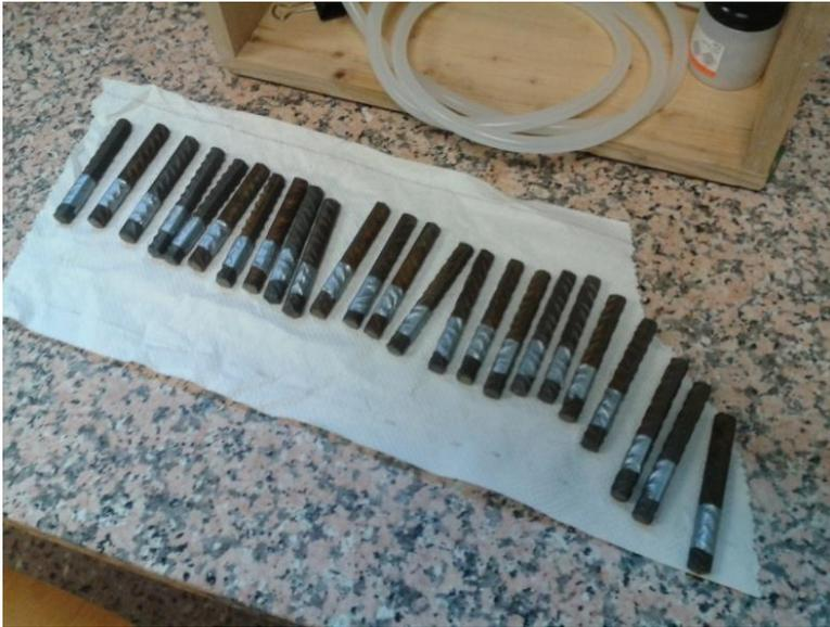
Fig. 3.3 Piezas tratadas con la disolución inhibidora.
