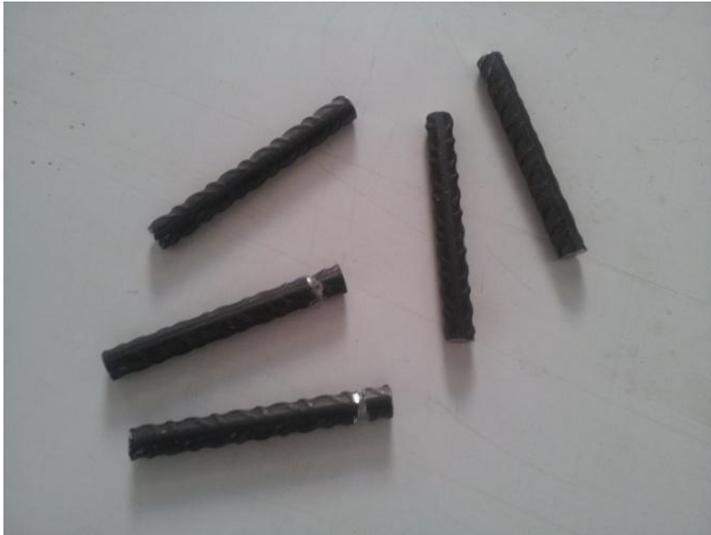
Fig. 5.1. Electrodo mecanizados y preparados para el acople del cableado.
