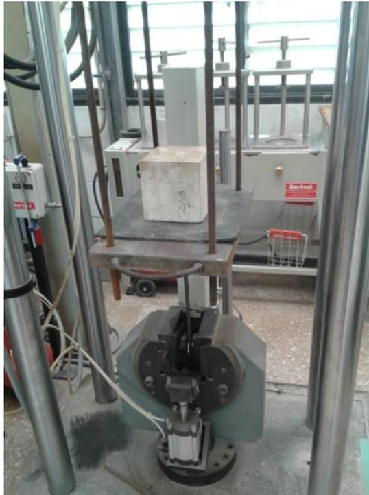
Fig. 9.18. Proceso de realización del ensayo de pull-out bajo cargas de servicio.
