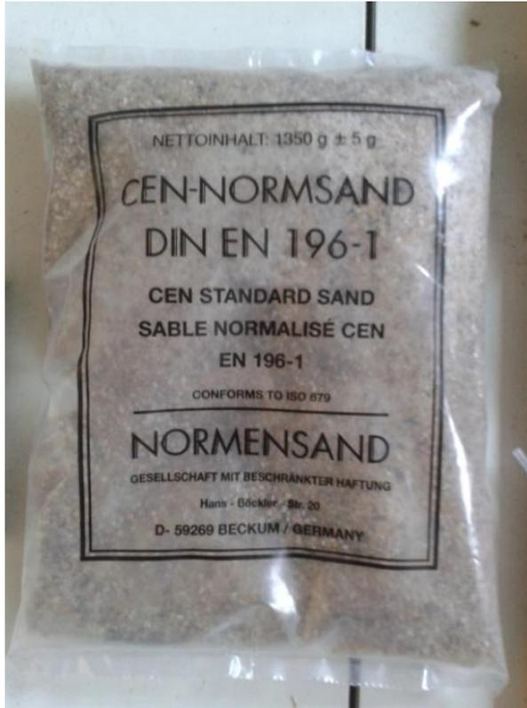
Fig. 3.5 Detalle del árido normalizado empleado.
