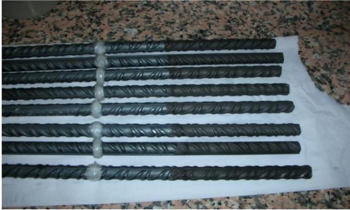
Fig. 9.2. Barras decapadas preparadas para la siguiente fase del proceso.
