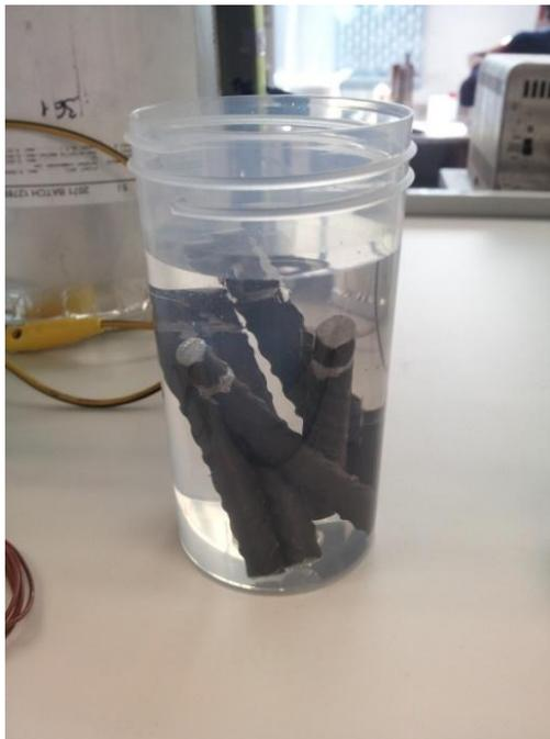
Fig. 5.2. Decapado químico con  $\text{H}_3\text{PO}_4$  1M.
