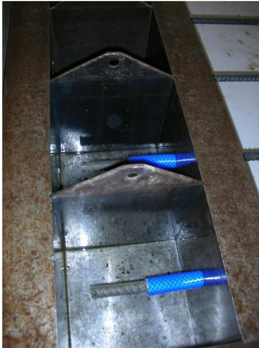
Fig. 9.6. Barras colocadas en el molde para los ensayos de pull-out bajo cargas de servicio y fatiga.
