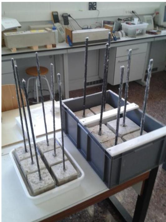
Fig. 9.19. Probetas dispuestas en las cubetas con disolución NaCl 0,5M.
