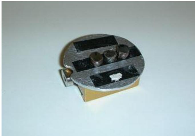
Fig. 8.7. Muestras dispuestas para el análisis SEM.
