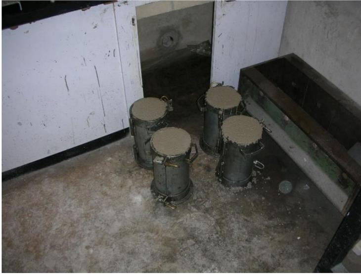
Fig. 9.13. Probetas cilíndricas para ensayo de rotura a compresión.
