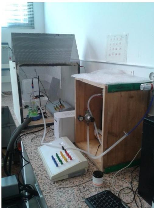
Fig. 5.7. Montaje para la generación de la monocapa con el método natural.
