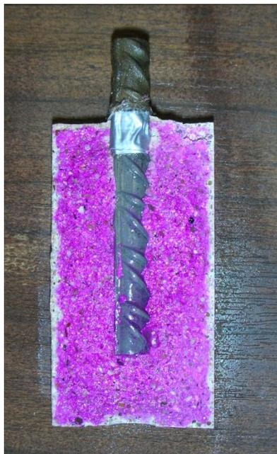
Fig. 1.3 Ensayo de profundidad de frente carbonatado. Fuente propia.
