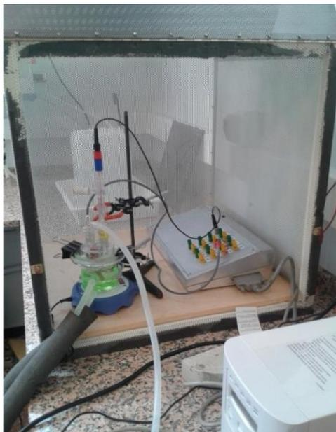
Fig. 2.16 Detalle del montaje de la celda dentro de la jaula de Faraday. Fuente propia.
