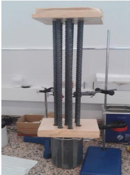
Fig. 9.1. Barras de acero sometidas al proceso de decapado químico.
