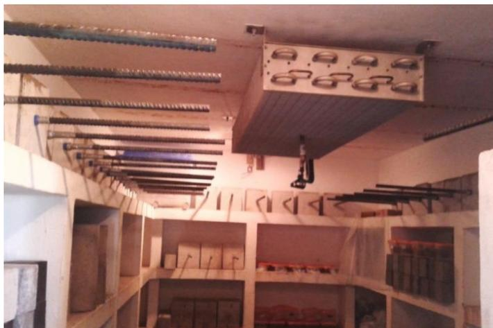
Fig. 9.12. Probetas colocadas en la cámara de curado.
