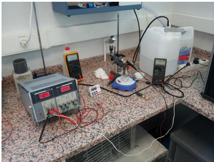
Fig. 5.9. Montaje de componentes para el procedimiento de electrolisis.
