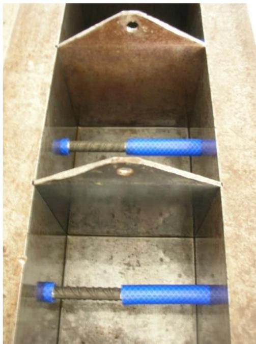
Fig. 9.8. Detalle de las barras colocadas en el molde: ensayo de pull-out hasta el agotamiento.
