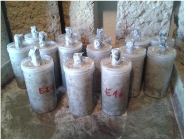
Fig. 3.7 Probetas colocadas en la cámara de curado con el extremo saliente protegido con vaselina.
