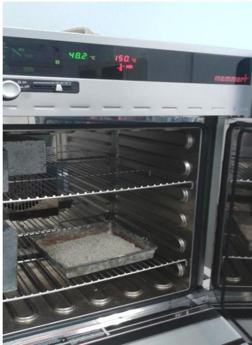
Fig. 9.9. Secado de una muestra de árido para el cálculo del contenido de humedad.
