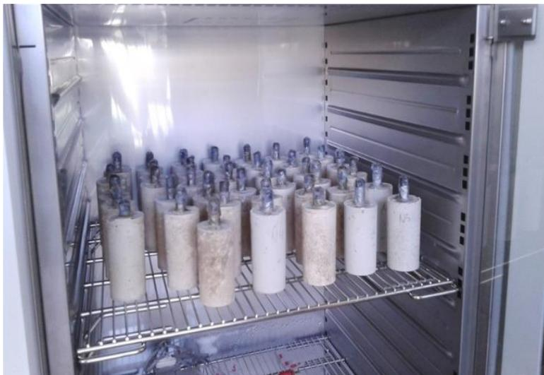
Fig. 8.2. Probetas en estufa: secado previo al proceso de carbonatación acelerada.
