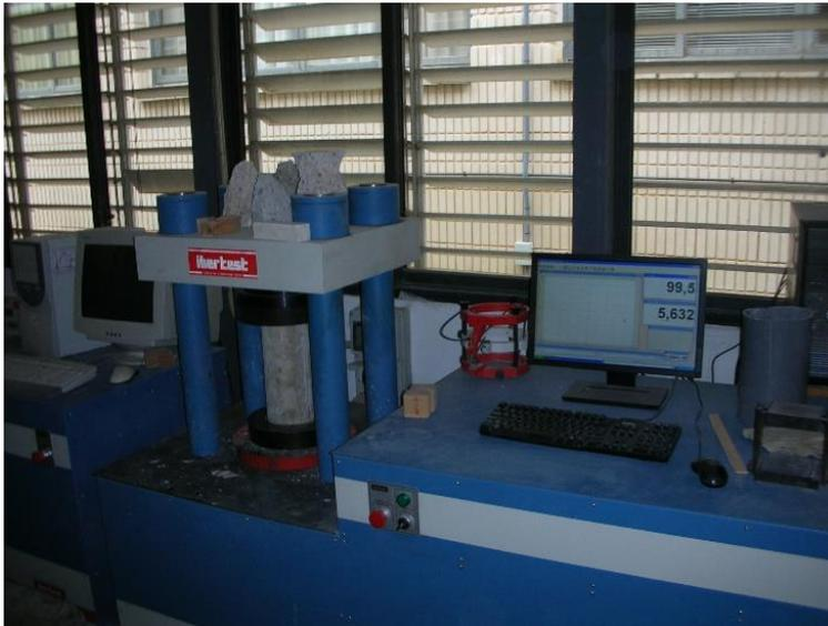
Fig. 9.14. Ensayo de rotura a compresión.
