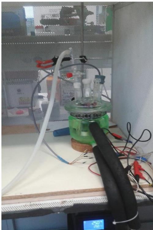
Fig. 6.2. Detalle de la celda de ensayo de tres electrodos.
