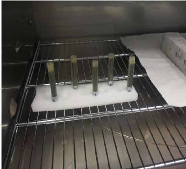
Fig. 2.13 Curado de resina en horno. Fuente propia.
