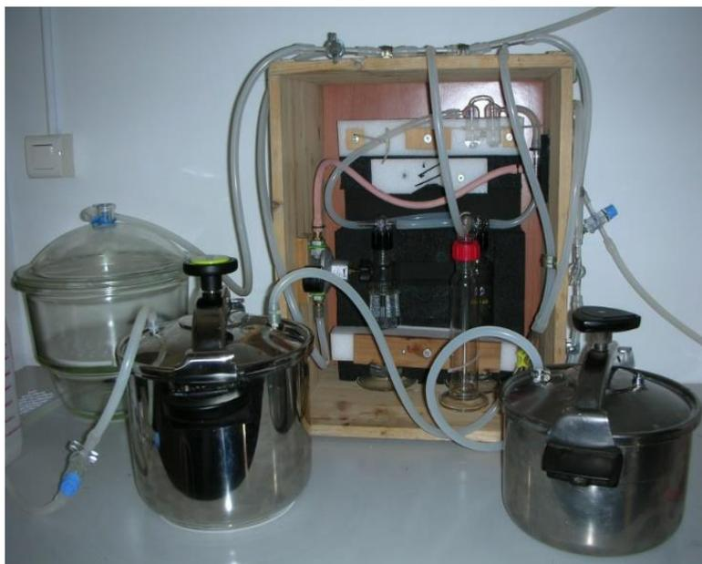
Fig. 8.3. Componentes del sistema de carbonatación acelerada.
