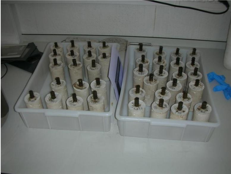
Fig. 3.8 Probetas listas para sumergirlas en las disoluciones.
