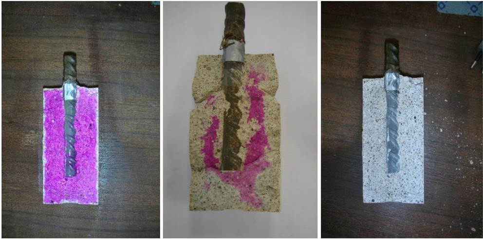
Fig. 8.5. Diferentes fases de carbonatación: carbonatación superficial (izquierda), carbonatación avanzada (centro) y carbonatación total (derecha).
