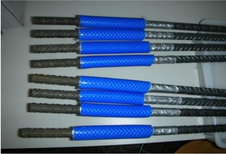
Fig. 9.5. Barras preparadas para colocar: ensayos de pull-out bajo cargas de servicio y fatiga.
