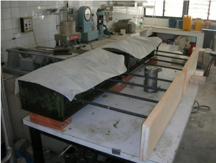
Fig. 9.11. Probetas realizadas a la espera del desencofrado.
