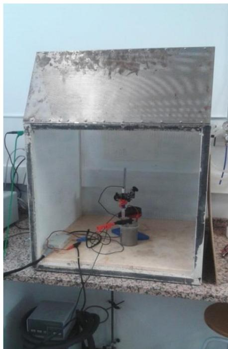
Fig. 8.6. Proceso de realización del ensayo LPR en probeta de mortero.
