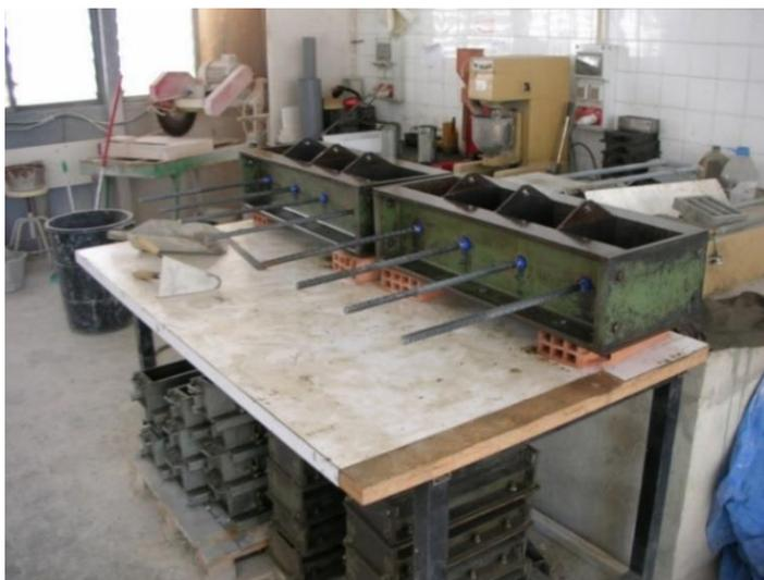
Fig. 9.7. Barras colocadas en el molde: ensayo de pull-out hasta el agotamiento.
