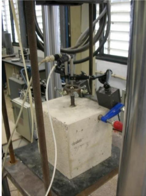
Fig. 9.17. Detalle del ensayo de pull-out hasta el agotamiento.
