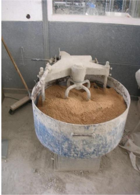
Fig. 9.10. Mezcla de componentes en la hormigonera previo al amasado.
